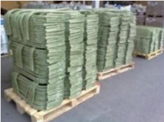
Cadres façonnés à l'usine
